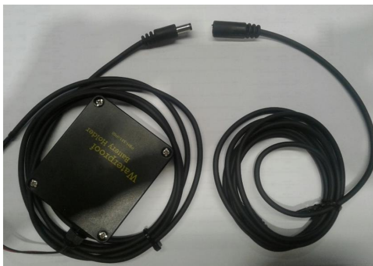
Fig. 18 – Conexión de la caja de baterías
