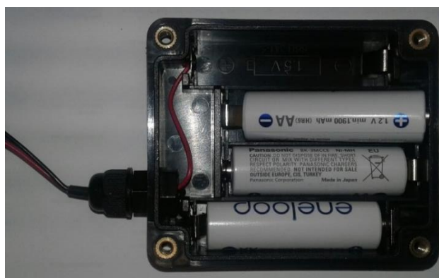
Fig. 21 – Sustitución de las pilas en la caja de pilas
