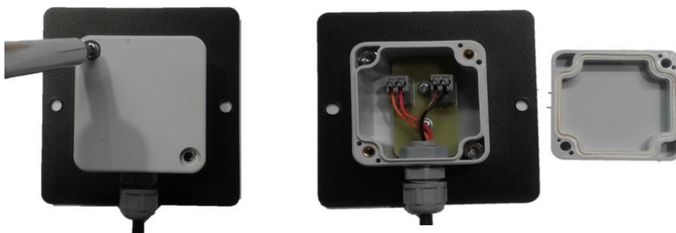
Rysunek 10 – Otwieranie puszeki panelu sterowania
