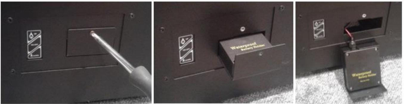
Abb. 9 - Herausnahme des Batteriebehälters
