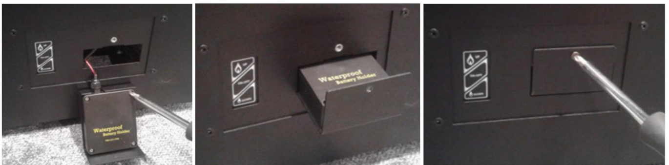
Abb. 11 - Hineinstecken des Batteriebehälters
