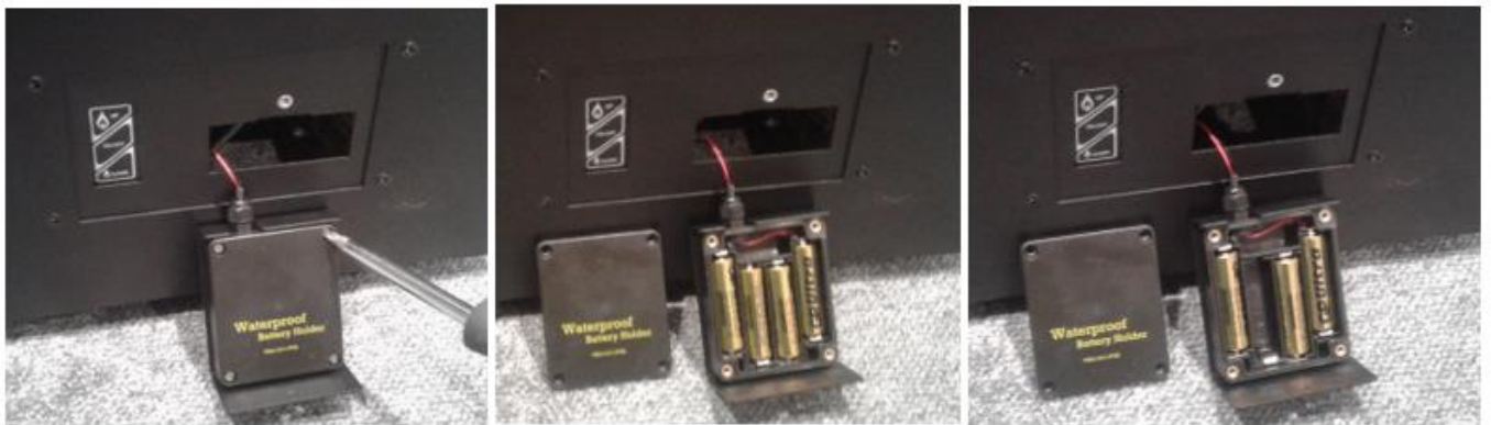
Abb. 10 - Batterientausch im Batteriebehälter
