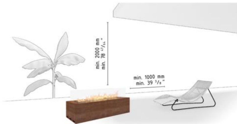
Abb. 1 - Mindestabstand zu brennbaren Materialien
