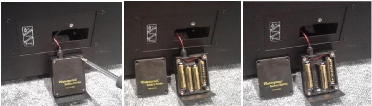
Abb. 10 - Auswechseln der Batterien im Behälter
