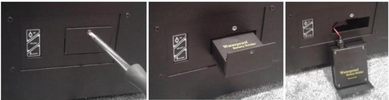
Abb. 9 - Abnehmen des Batteriebehälters
