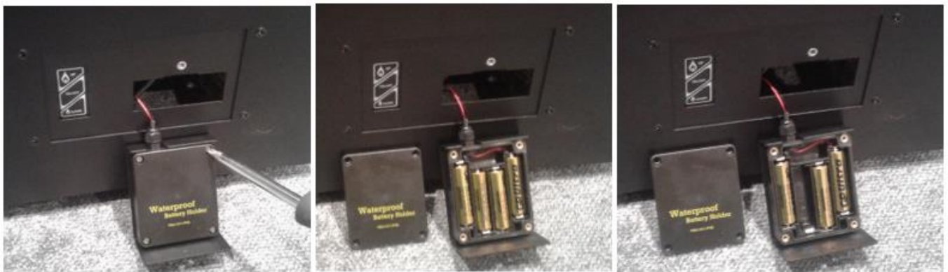
Fig. 10 - Sustitución de las pilas en el contenedor
