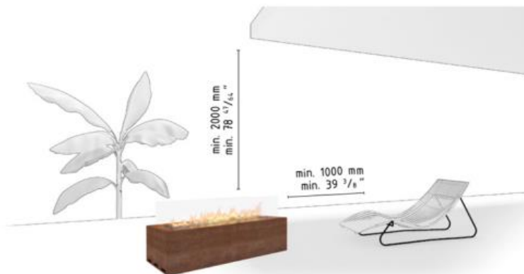
Fig. 1: Distancia mínima a materiales inflamables
