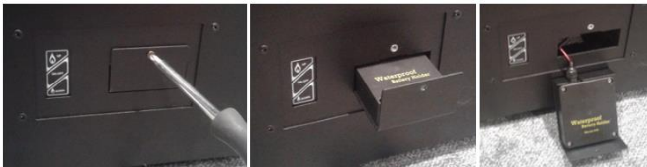
Fig. 9 - Rimozione del contenitore della batteria
