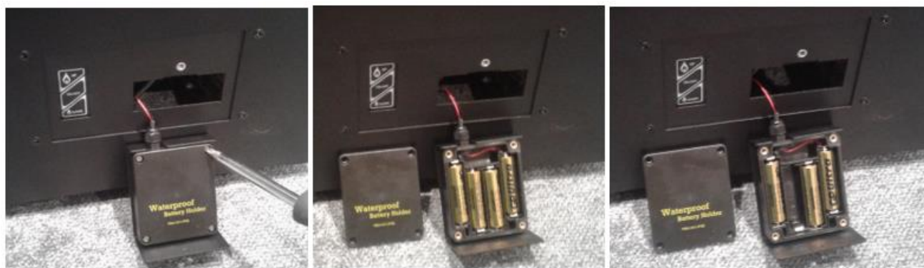
Fig. 10 - Sostituzione delle batterie nel contenitore
