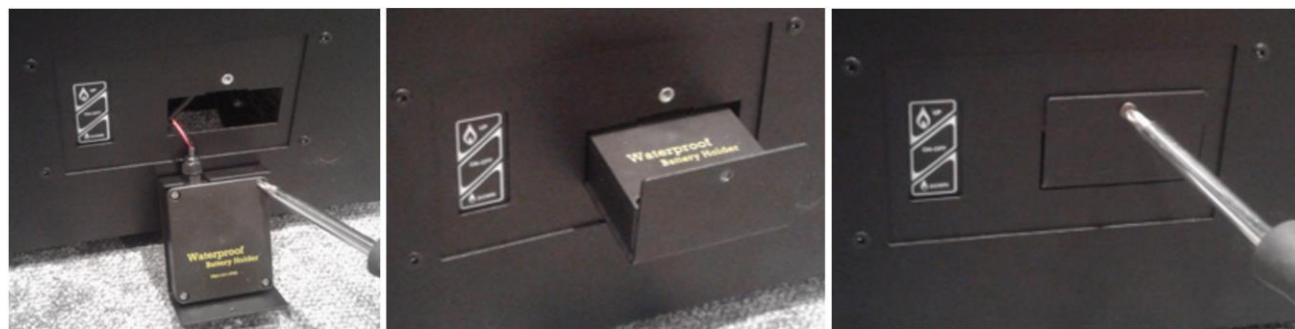
Fig. 11 - Rimontaggio della scatola della batteria
