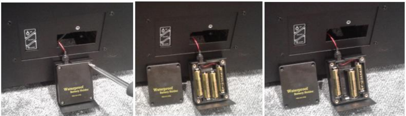
Fig. 10 – Wymiana baterii w puszcze
