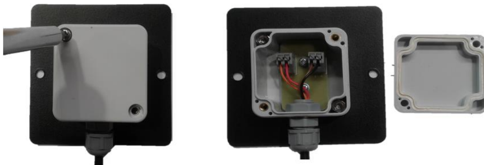
Abb. 9 - Öffnen der Rückseite des Wandschalters
